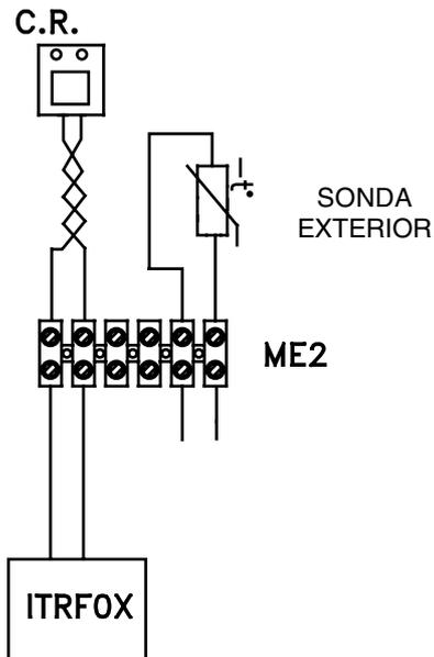
El termostato o cronotermostato ambiente se instalará como se indica en el esquema después de haber quitado el puente presente en el terminal de conexión de 6 polos. Los contactos de termostato ambiente o cronotermostato se tienen que dimensionar para una tensión de 230 V.
